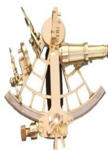
Instrument utilisé pour déterminer la position géographique de l'observateur. Il était particulièrement utilisé pour la navigation . Sa construction repose sur les lois de la réflexion de la lumière. Le sextant a la forme d'un secteur d'un angulaire de 60°.
