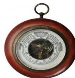
La pression mesurée par le baromètre s'exprime en millimètres de mercure. Il permet de mesurer indirectement des
